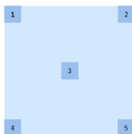
图 3 (156 mm×156 mm) 光斑测试区域内 5 个测试位置示意图
